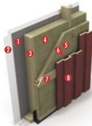
УТЕПЛЕНИЕ КАРКАСНОЙ СТНЫ. 1 - внутренняя отделка, 2 - пароизоляция, 3 - деревянный каркас, 4 - PAROC UNS 37, 5 - PAROC WAS 25, 6 - воздушная прослойка, 7 - регулирующие брусья, 8 - отделка
